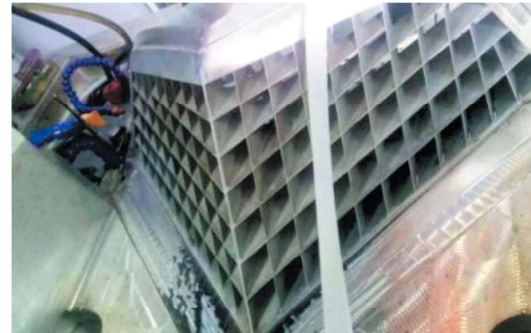
• 用于飞机的唇口格栅——7050厚板 Applied to the lip mouth grille of aircraft——7050 plates
